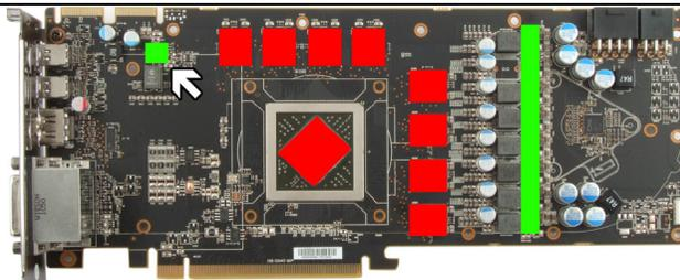
Bringen Sie eine dünne Schicht Wärmeleitpaste auf die GPU und die RAM-Beisteine auf (im Bild rot markiert). Die verwendete Wärmeleitpaste darf nicht elektrisch leitfähig sein! Schneiden Sie aus dem beiliegenden Wärmeleitpad passende Stücke zu und legen Sie sie auf die Spannungswandler (im Bild grün markiert) auf.
